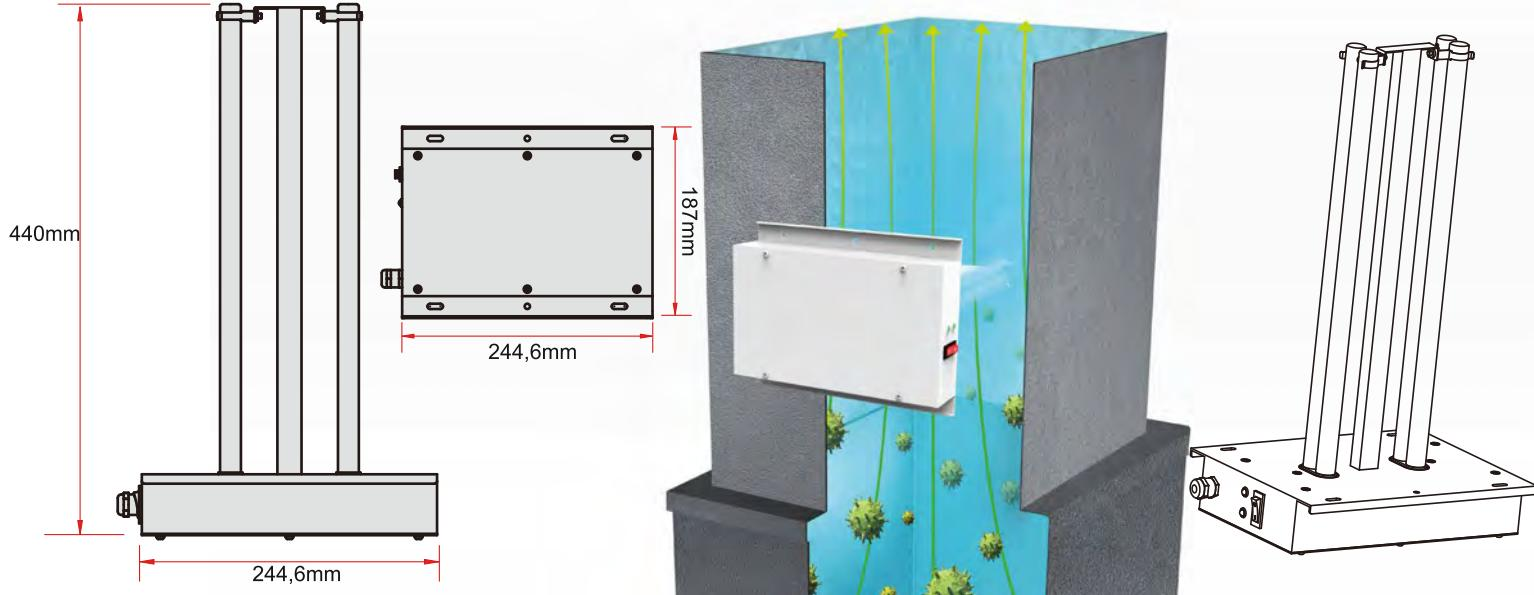
Lampada germicida UV-C potenza 72 w, adatta alla sterilizzazione dell'aria in condotte di ospedali, palestre, scuole, ristoranti, appartamenti, negozi, uffici. Realizzata in Acciaio INOX AISI 304. Ha una durata della lampada maggiore di 8000 ore. Peso netto di Kg. 1,1. Iserita all'interno delle condotte aria condizionata elimina la carica batterica.
