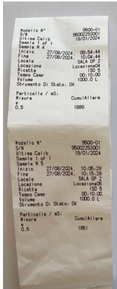
Per la classe ISO 5, il valore minimo previsto dalla ISO 14664-1 per le particelle da 0,5  $\mu\text{m}$  è di 3520, il valore rilevato è stato inferiore a tale limite e quindi il locale rientra nella classe ISO 5.
