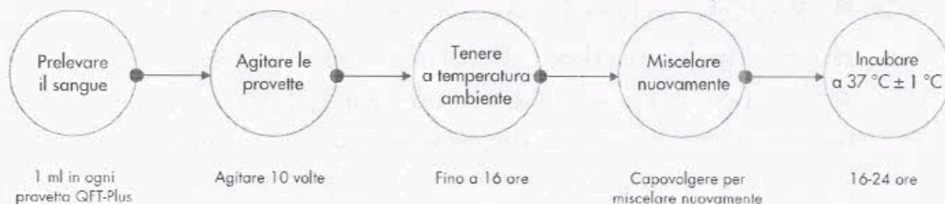
Figura 1. Opzione di raccolta ematica: prelevare il sangue direttamente nelle QFT-Plus Blood Collection Tubes e tenere a temperatura ambiente.
